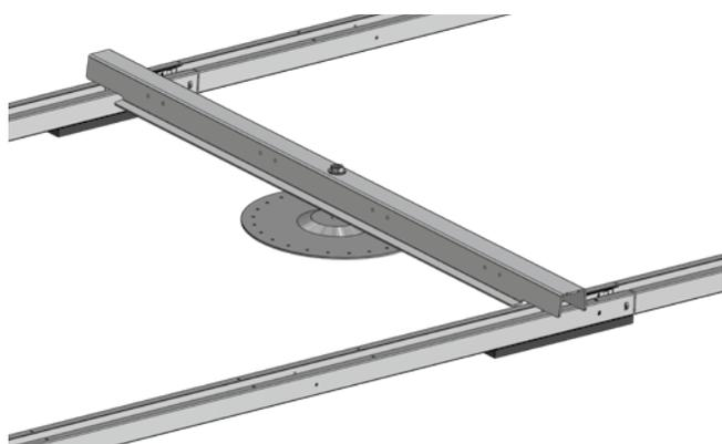
Positionnez les unités de base de manière à ce que l'ancrage de toit préinstallé soit précisément centré entre les deux rails en C. Fixez le profil d'ancrage sur l'ancrage de toit en le sécurisant avec une rondelle et un écrou, conformément au manuel d'installation du fabricant de l'ancrage de toit.
